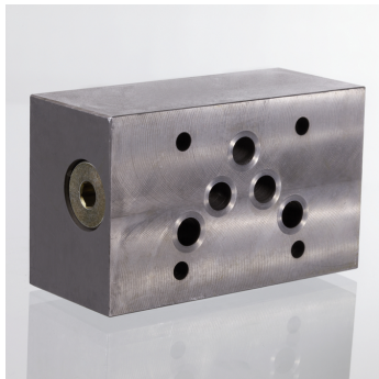
Modelis Starpplātņu vārsts Eksploatācijas spiediens maks. 315 bar Savienojums ISO/Cetop 05 size 10
